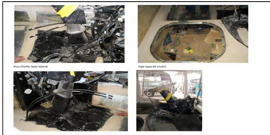
Imagen 10: Forro del piso delantero del conductor. Fuente: Carrocerías MegaSantacruz.
