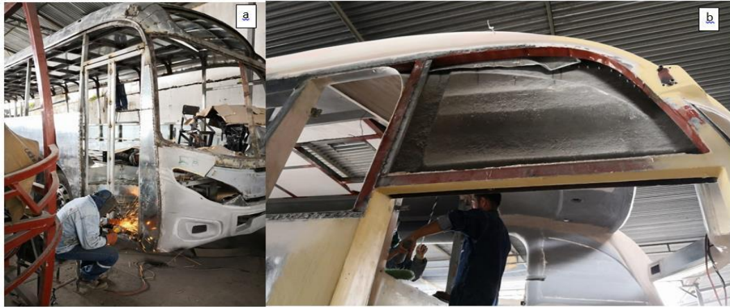
Imagen 1: Imagen armado de techo Fuente: Carrocerías MegaSantacruz.
