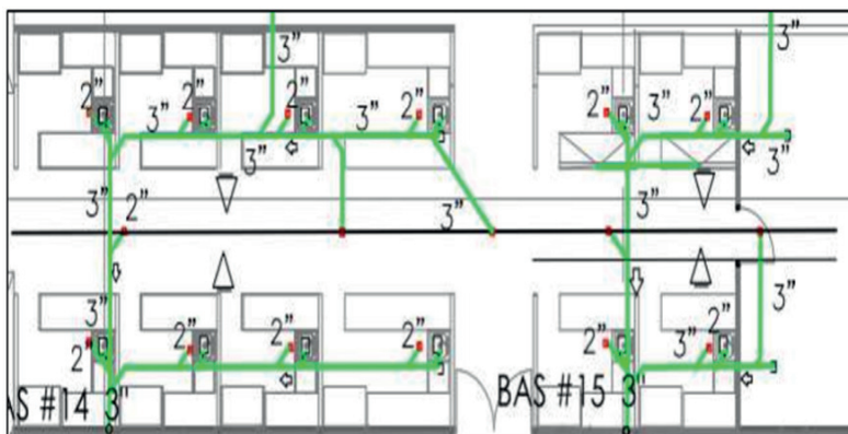
Figura 37. Sistema de desagües [40]
