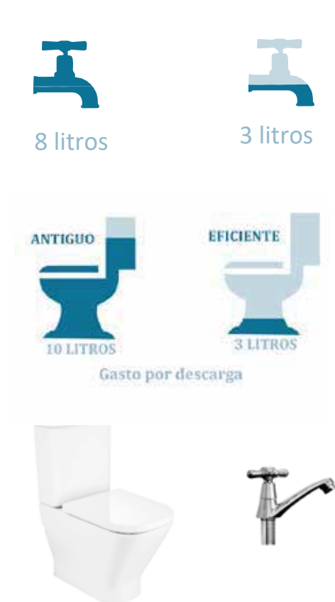
Figura 25 Comparativa de sistemas tradicionales y de ahorro en griferías e inodoros Fuente: Elaboración propia, 2022
