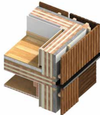
Figura 4: Detalle constructivo del CLT Fuente: David Carrillo Valdés Ingeniero Civil de Eligemadera (2020)
