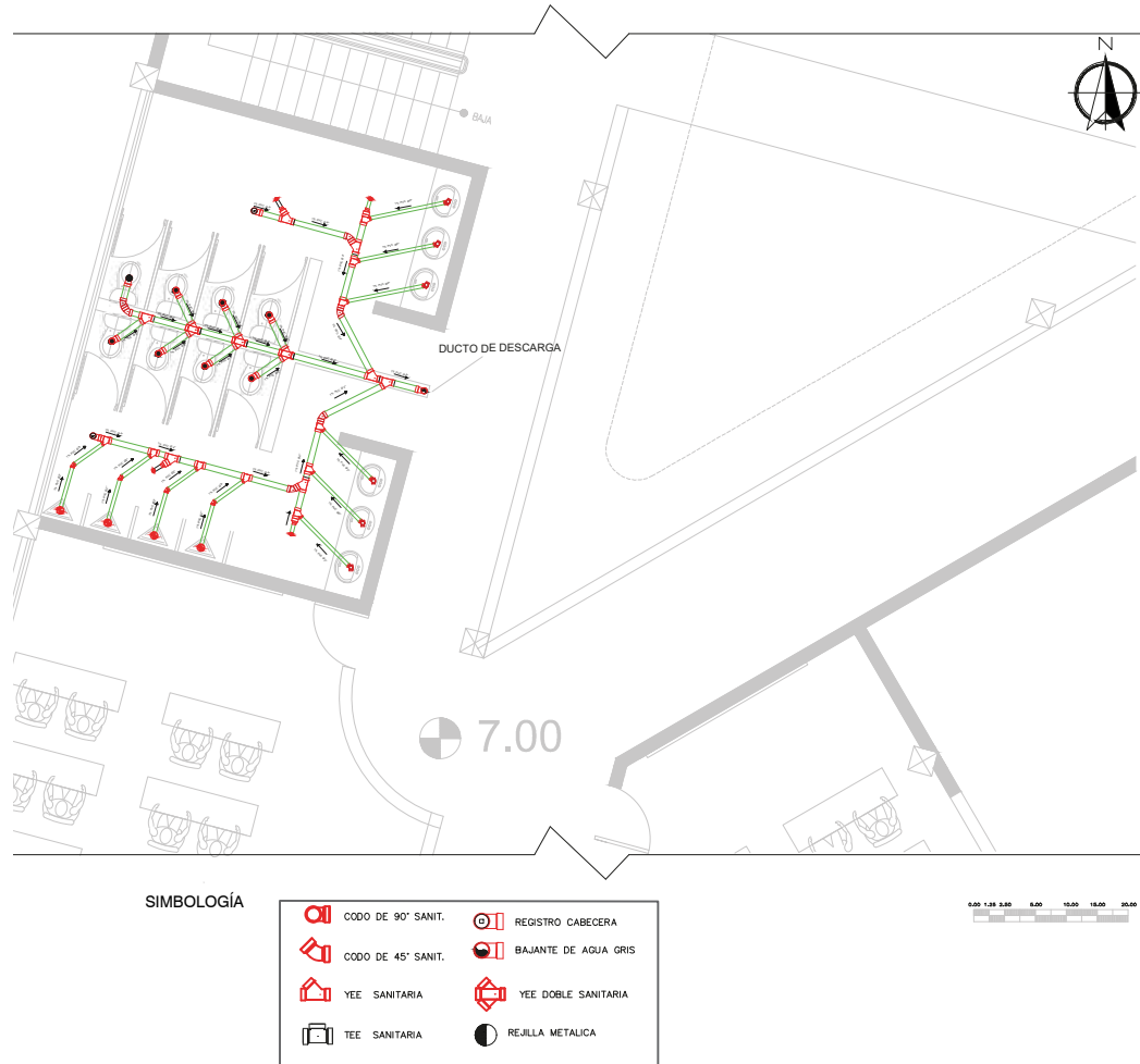
Figura 50: Plano Hidrosanitario Fuente: Taller de aplicación avanzada, 2021
