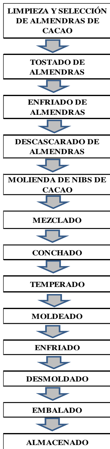
Grafico 31.- Flujo actual de la fábrica en la elaboración del chocolate. Fuente: Proceso de elaboración de chocolate instalaciones Corporación “La Pepa de Oro” Elaborado por: Álvaro Saucedo
