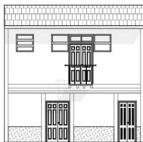
Vivienda N°17-V17M6 Fachada principal: 43,80m 2 -100% Vanos: 25,68% Llenos: 74,32% Predomina el lleno sobre el vano
