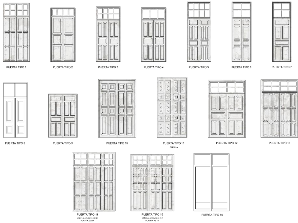
Figura 85. Puertas estado actual
