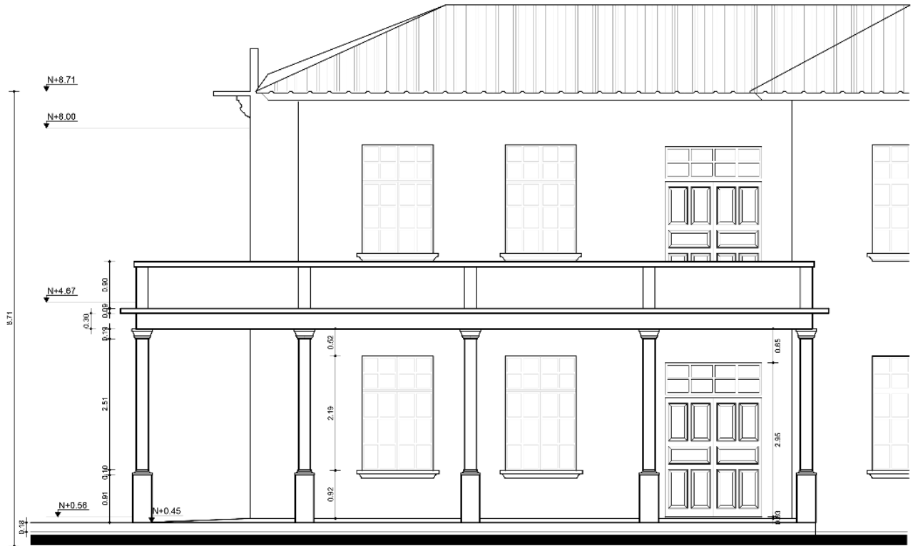
Figura 84. Recuperación del portal fachada sur oeste
