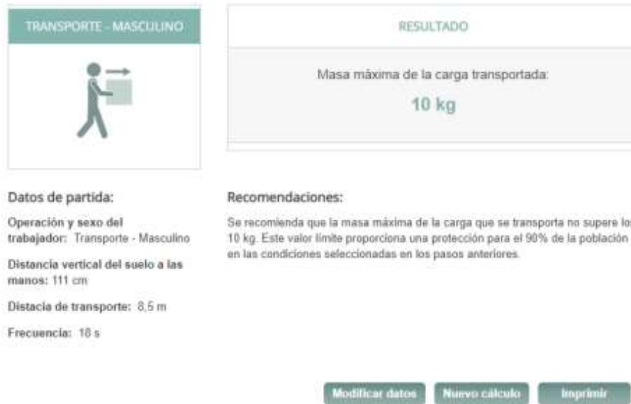
Figura 122. Aplicación del método INSHT (Levantamiento de paredes) Elaborado por: Karen Villafuerte Fuente: (INSST, 2020).
