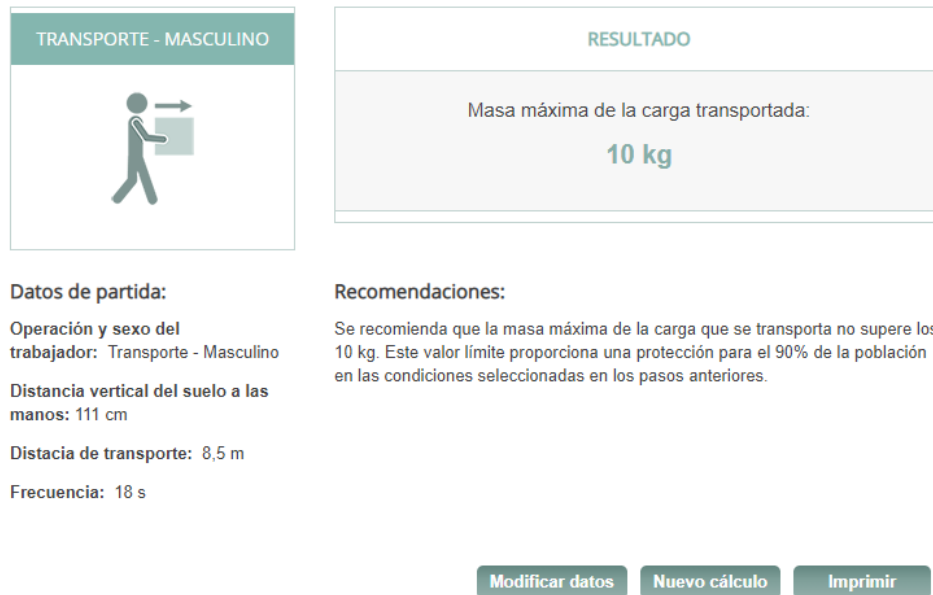
Figura 110. Aplicación del método INSHT (Fundición de loza de cimentación)
