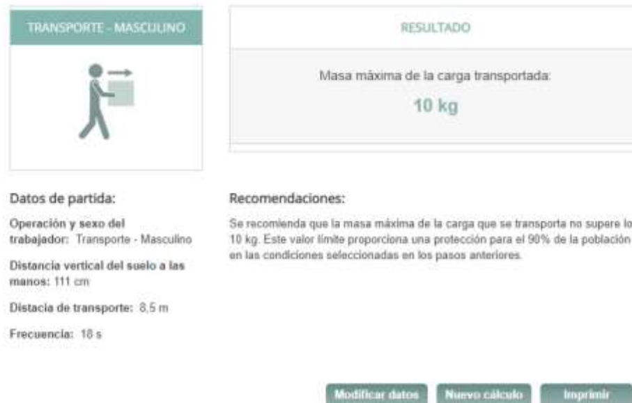
Figura 124. Aplicación del método INSHT (Levantamiento de paredes)
