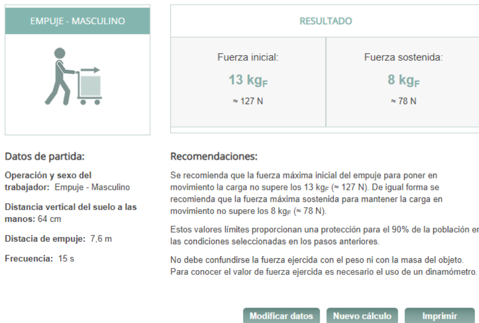
Figura 123. Aplicación del método INSHT (Levantamiento de paredes)
