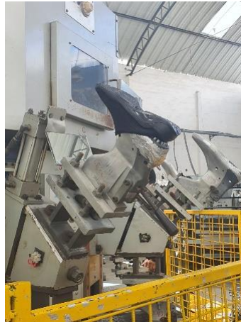
Imagen 6. Calzado desprendido de horma
