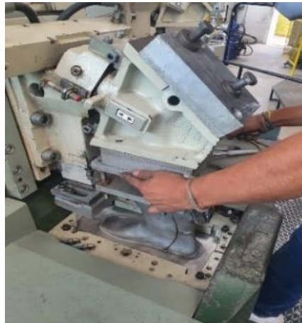
Imagen 2. Calibración de moldes y hormas
