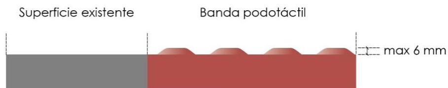
Figura 3 Descripción gráfica de una banda podotáctil
