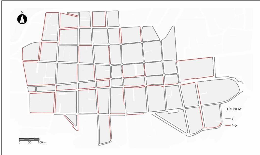
Figura 43 Continuidad de aceras
