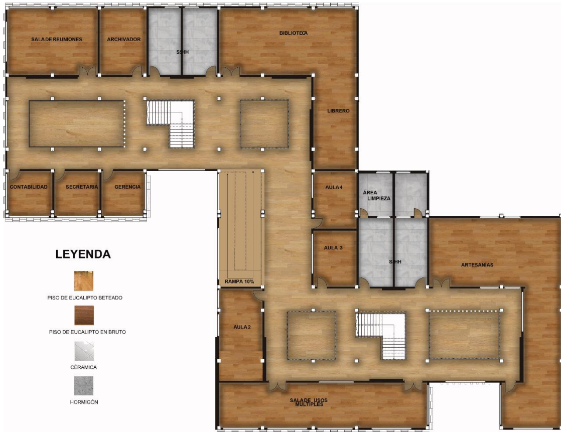
Figura 59. Planta de Pisos Planta Alta
