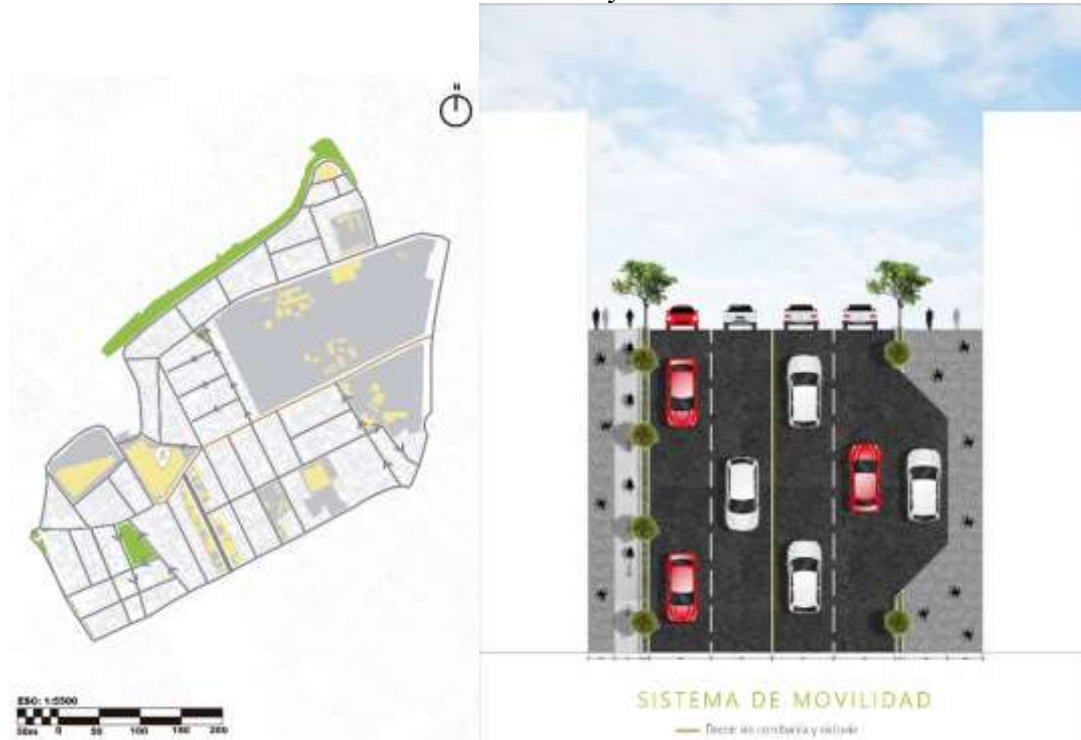
Figura 114. Doble vía con bahía y ciclovía
