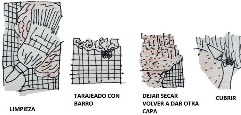
Figura 97 tarajeado de pared
