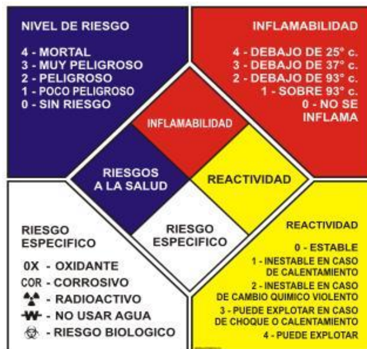
Figura 20: Señalización de Materiales Peligrosos.
