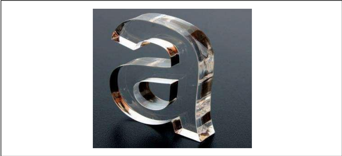
Figura N° 28. Letra de acrílico cortada mediante la técnica láser.
