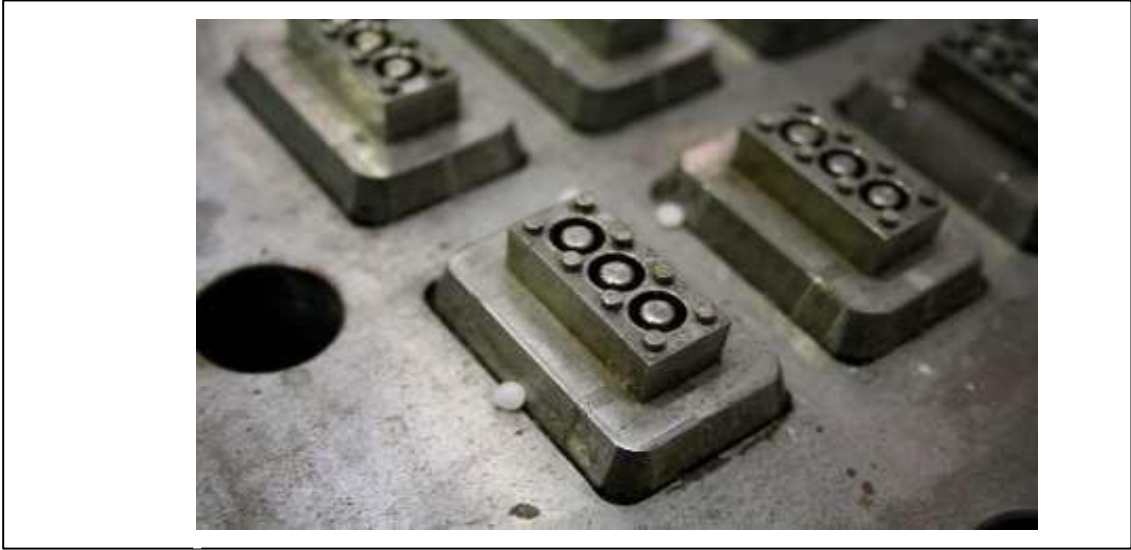
Figura N° 27 Moldes para la fabricación de piezas de lego mediante inyección.
