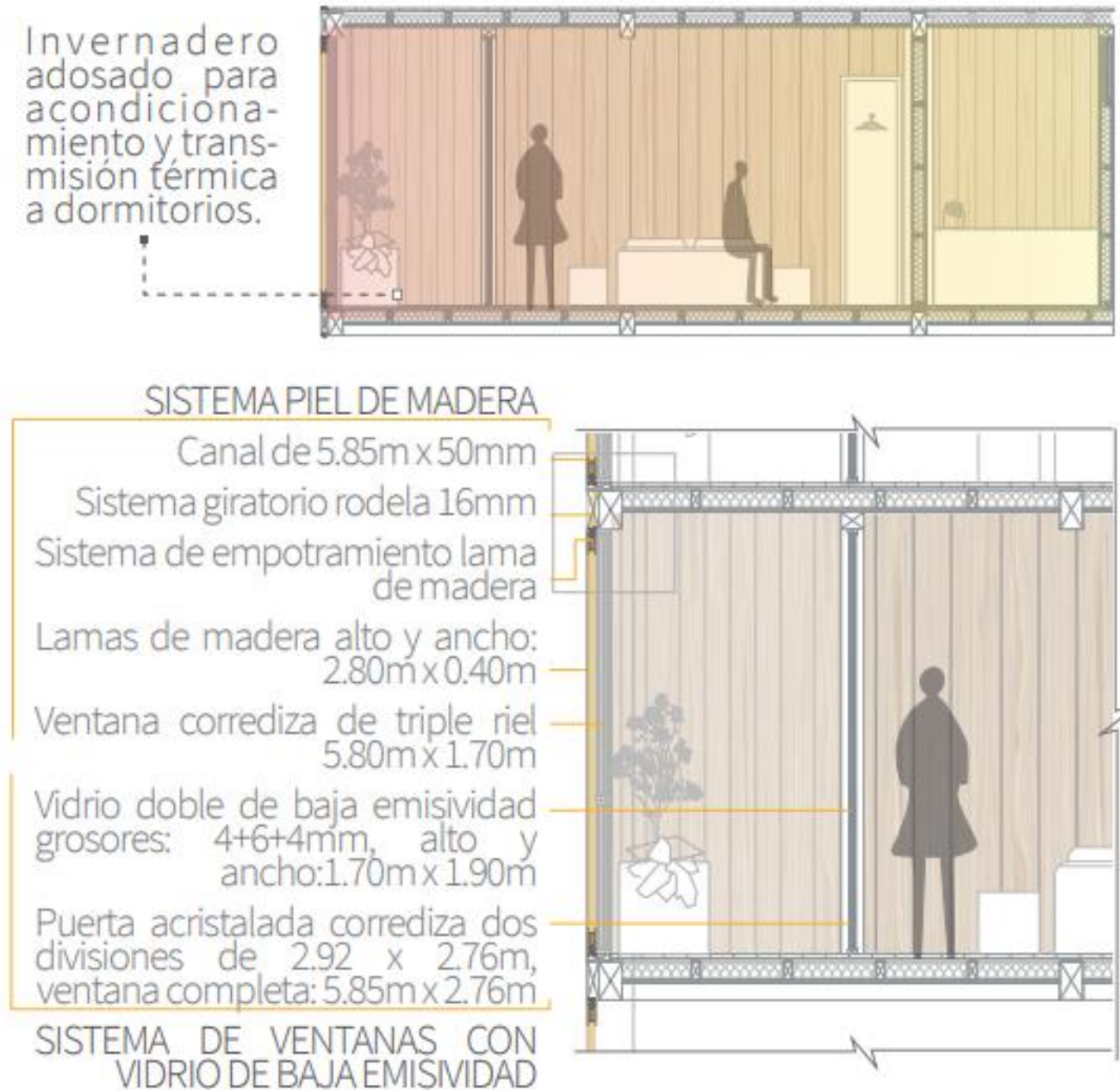
Gráfico 84 Detalle de invernadero adosado y materialidad
