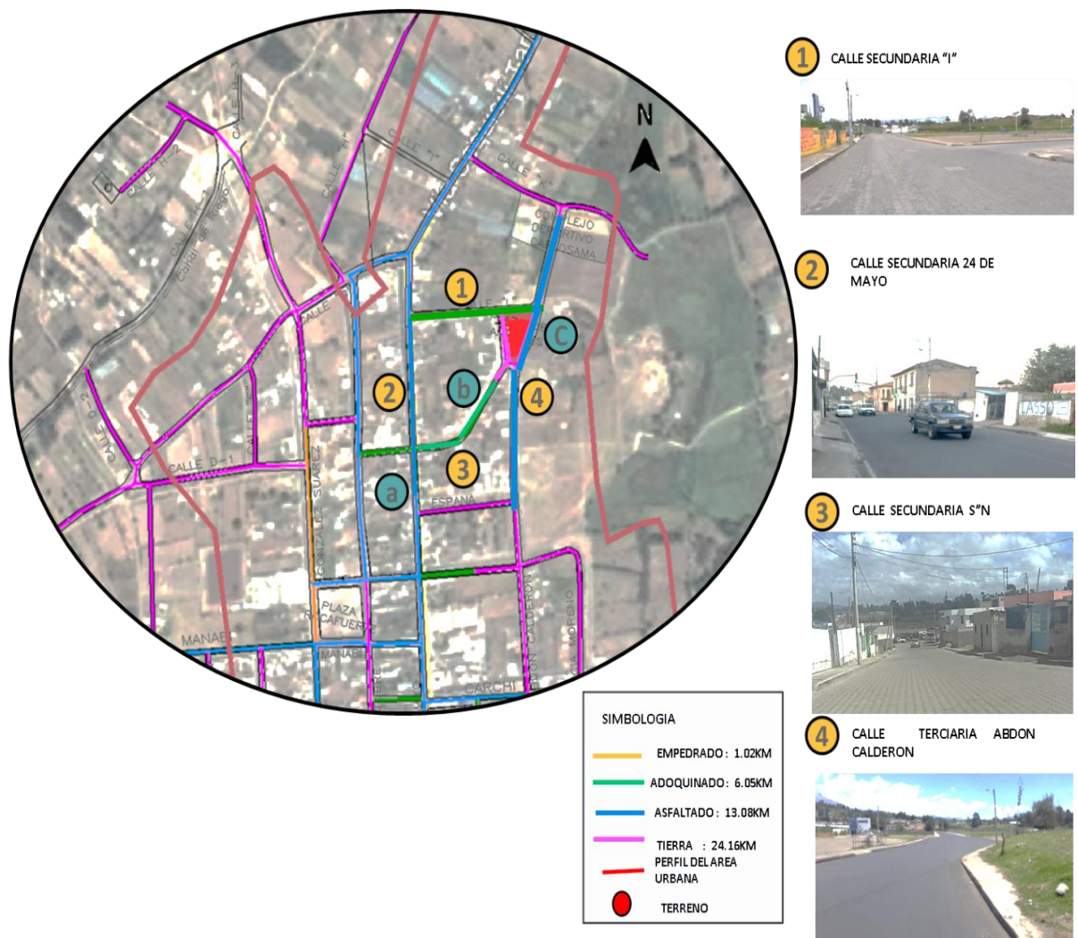
Gráfico No. 48.-Análisis de capa de rodadura en el terreno de estudio.
