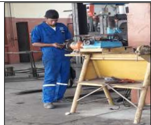
Imagen 15: Ayudante del mecánico lijando una pieza con un esmeril. Fuente: Autoridad Portuaria de Esmeraldas.
