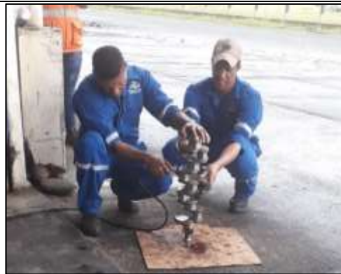
Imagen 13: Mecánico limpiando una pieza de un motor con aire comprimido. Fuente: Autoridad Portuaria de Esmeraldas.
