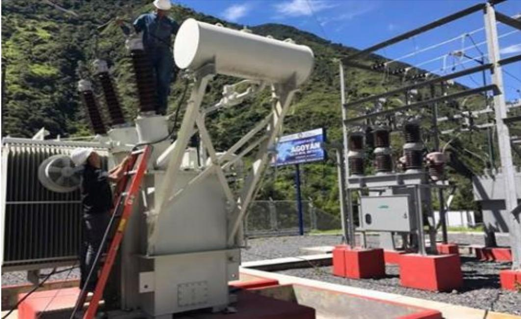
**Imagen 3:** Ensayo de Factor de Potencia – Transformador 5MVA
