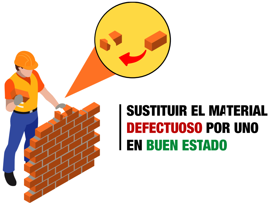
Gráfico 31. Mantenimiento en muros de adobe Elaborado por: Taipe, Santiago (2020)
