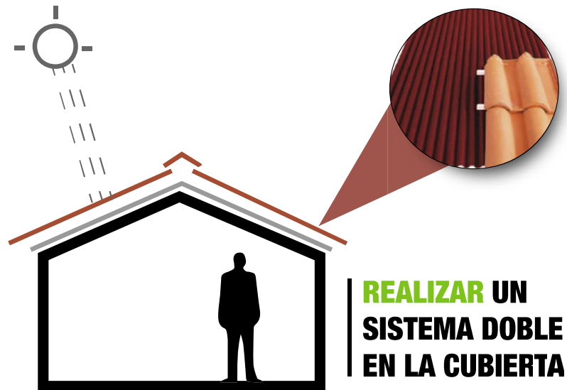
Gráfico 34. Esquema de sistema doble cubierta Elaborado por: Taipe, Santiago (2020)
