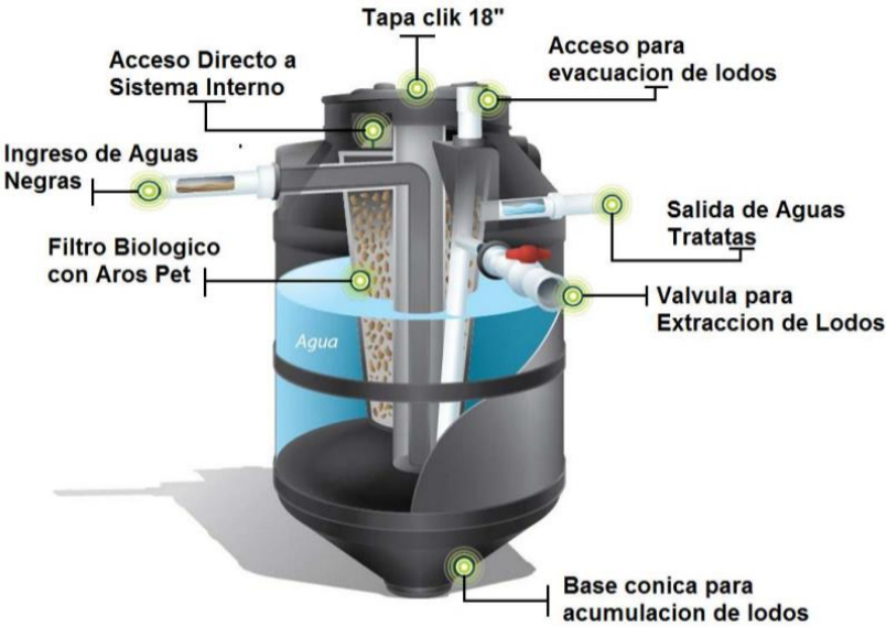
Figura 104. Sistema Bio gestor - tanque séptico
