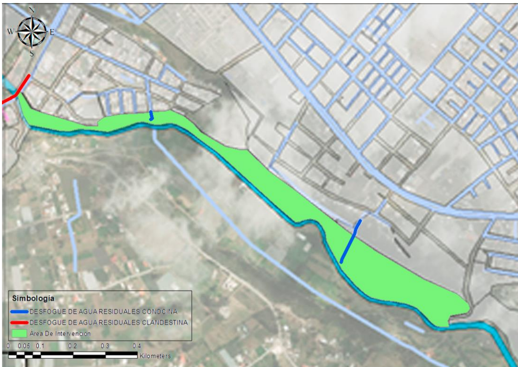
Ilustración N°28: Desfogue De Alcantarillado Conocido Fuente: Arq. Diana Orellana. Elaboración: Jaime Andrés Fiallos
