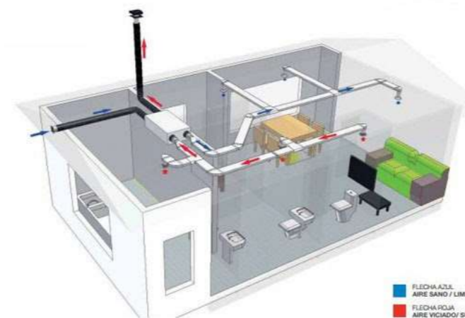
Imagen 105. Funcionamiento del sistema de ventilación. Fuente: Siber, (2015).
