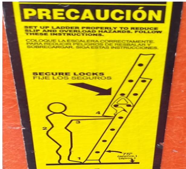
**Figura 24.** Colocación de escaleras.
