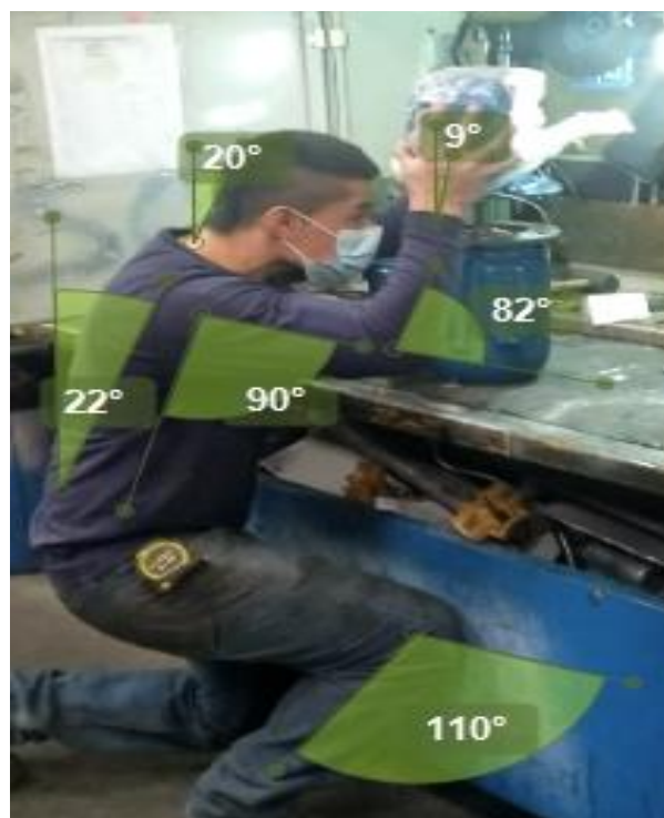
Figura N° 13 Posición P16 ensamble de caja reductora y motor
