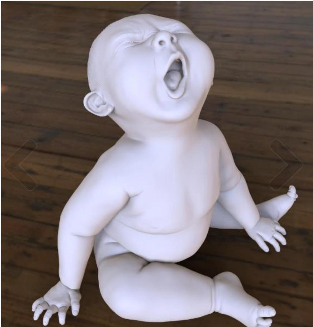
Imagen N° 26 Moldes pediátricos en formato 3D listo después de impresión
