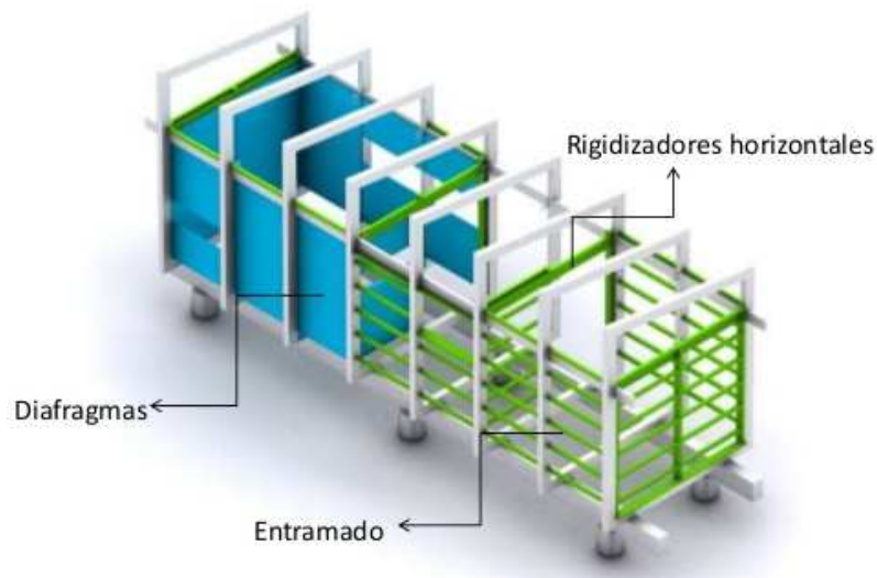
IMAGEN 32: Rigidizado de estructura
