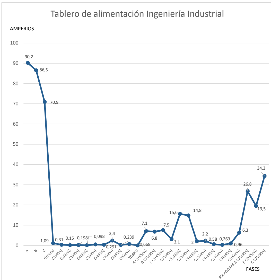
Gráfico No 27: Tablero de alimentación Ingeniería Industrial Fuente: El Investigador Elaborado por: El Investigador
