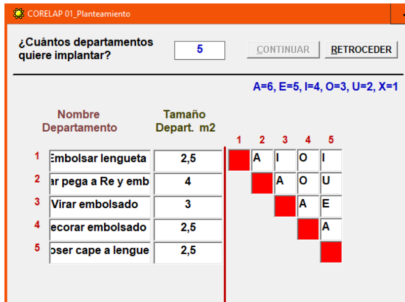
Figura 16: Relación entre departamentos de la elaboración de la lengüeta (Etapa II) Fuente: Buestán Cía. Ltda. Elaborado por: Mishell González
