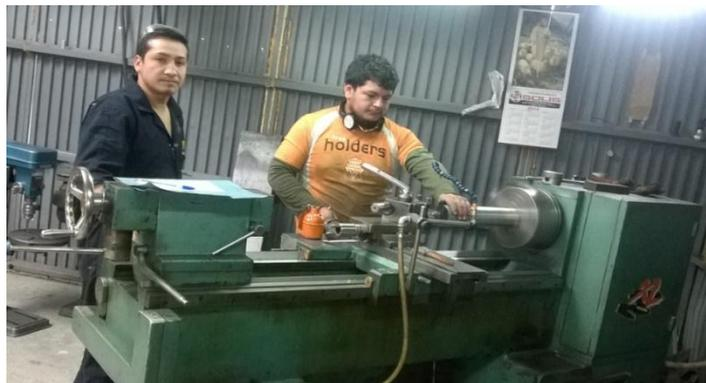
Figura N° 26.- Proceso de torneado tubo galvanizado.
