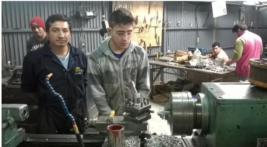
Figura N° 15.- Proceso de tornear cabezote.
