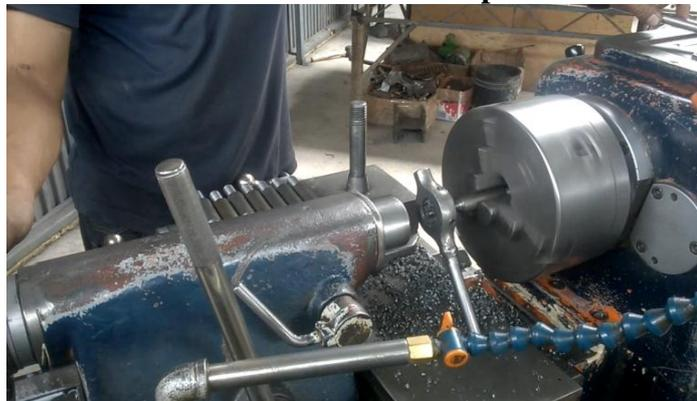
**Figura N° 21.-** Proceso de roscar terminal posterior.
