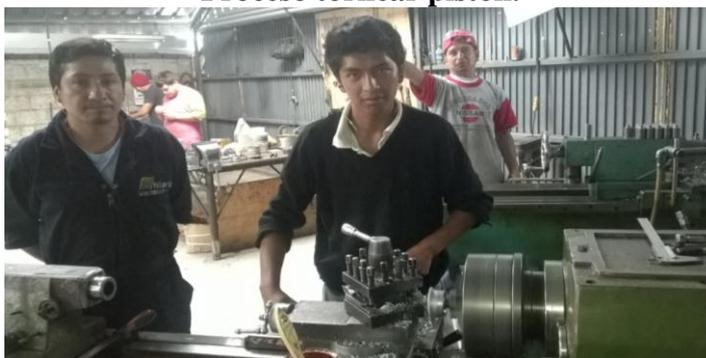
**Figura N° 19.-** Proceso tornear pistón.
