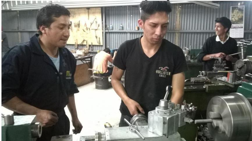
Figura N° 17.- Proceso de torneado eje de pistón.
