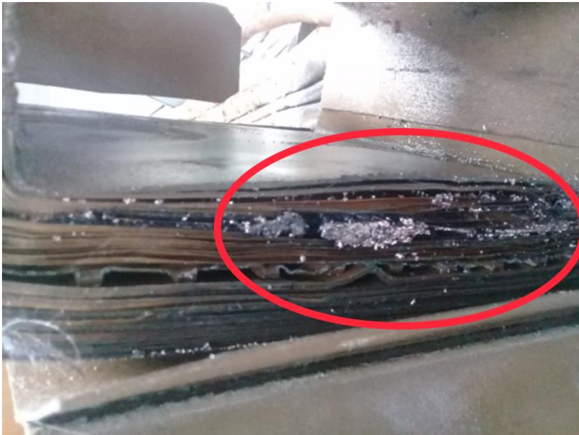
Figura 15 Efectos de las fallas de material en el proceso de construcción de bobinas
