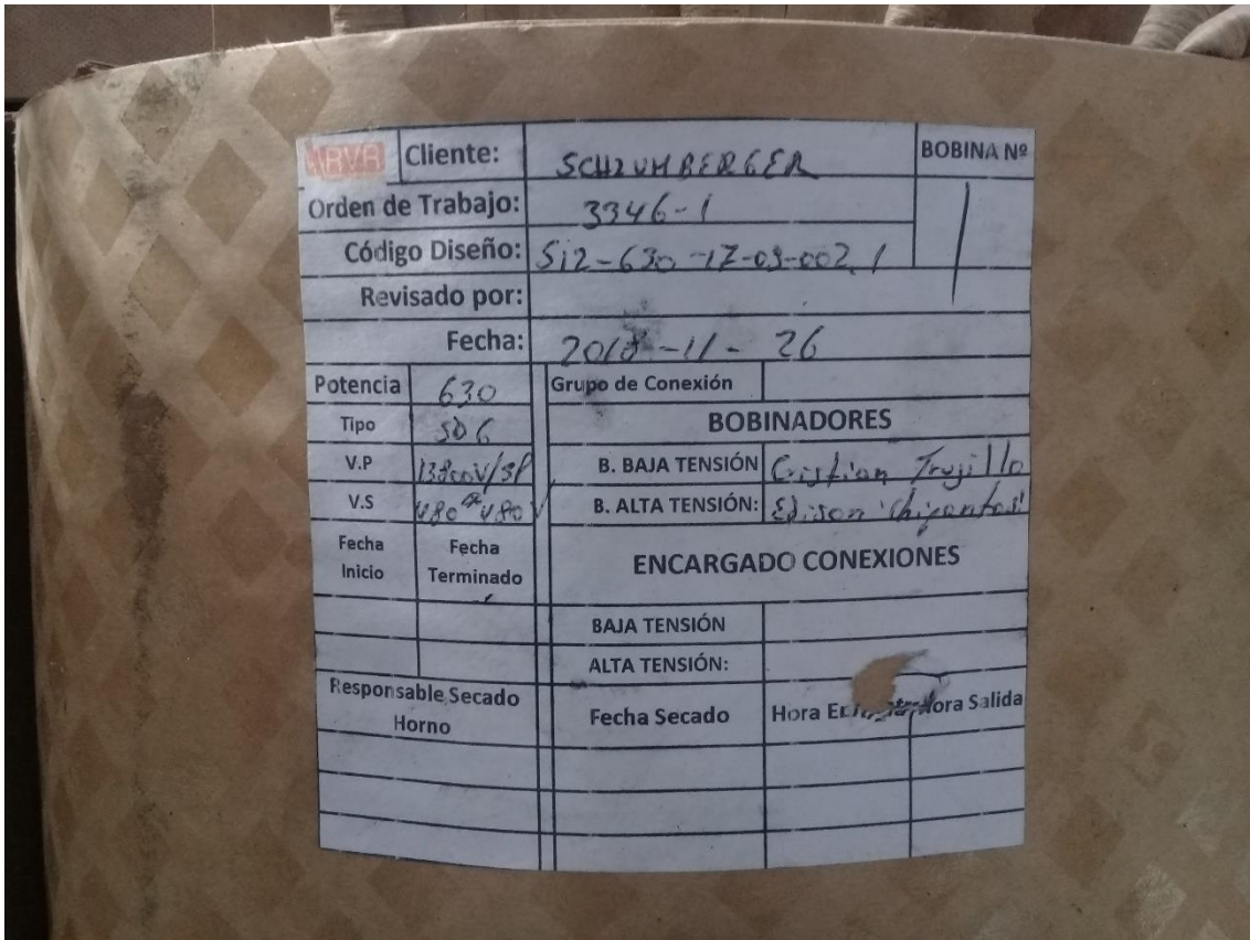
Figura 14 Identificación individual de las bobinas terminadas
