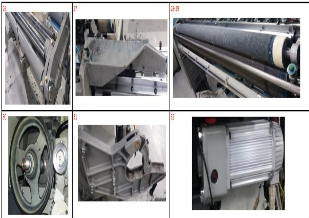
Figura N° 35: Fotografía partes sistema desenrollador y arrastre.
