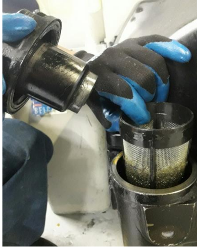
Figura N° 13: Fotografía mantenimiento de filtros de aceite.
