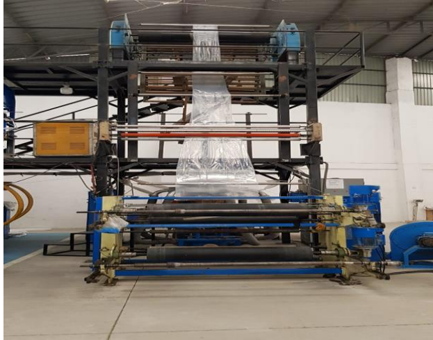
Figura 2: Envolvimiento de película plástica en un Bocín Fuente: M&M Plasticotopaxi
