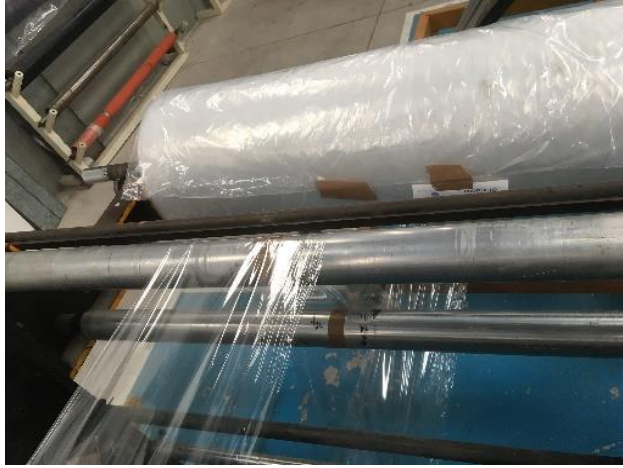
Figura 3: Montaje de bocín en la máquina cortadora Fuente: M&M Plasticotopaxi
