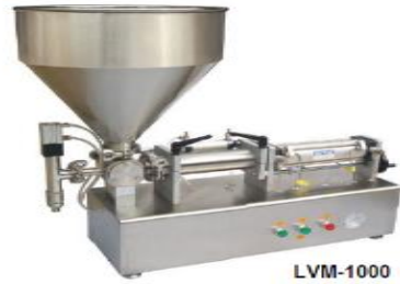
Imagen 16 Llenadora de líquidos de 4 pistones Fuente: Ecuapak Elaborado por: Isabel Cisneros
