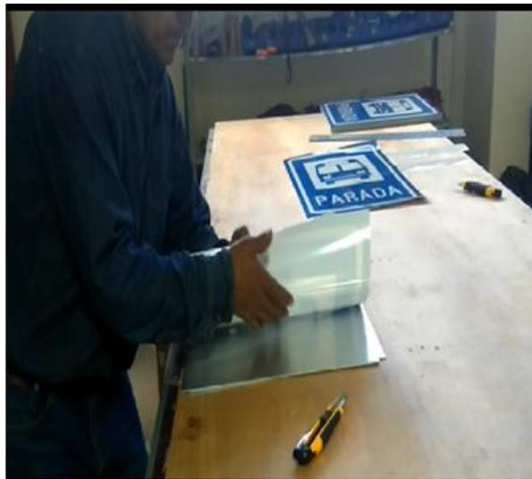
**Figura 6.** Pegado de señal vial en placas de aluminio
