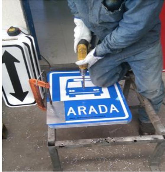
**Figura 9.** Perforado de señales
