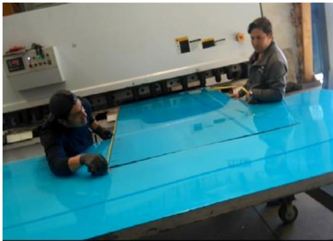
**Figura 5.** Corte de placas de aluminio
