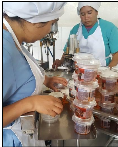
Imagen No. 10. Actividad de colocación de la tapa exterior.
