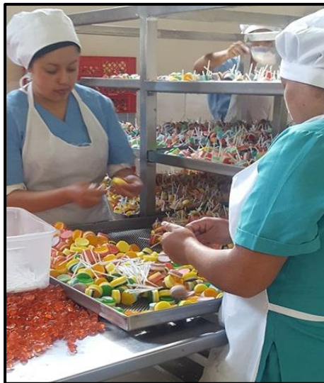
Imagen No. 19. Subproceso de colocación del palo de agarre.
