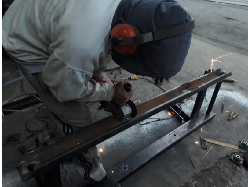
Anexo 9 Colocación de la señal para el corte del perfil de la estructura.
