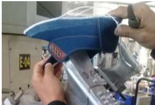
Imagen 3 Corte en la horma para amarrado.
