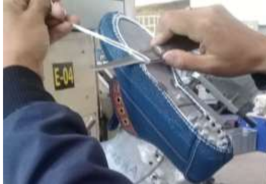
Imagen 5 Realización del nudo que sujetara al corte para la inyección.
