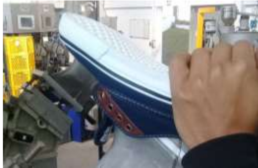
Imagen 8 Abrir los rines para proceder a descalzar el zapato inyectado.
