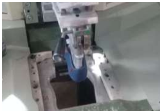
Imagen 7 Inyección de la suela al corte
