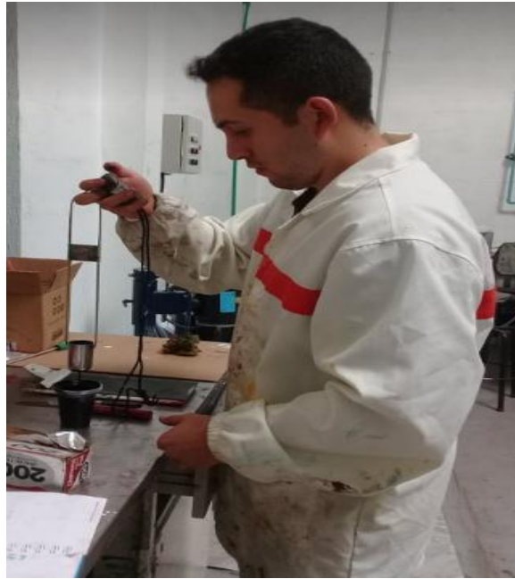
Figura 10 Medición de Viscosidad de Tintas. Fuente: QSI S. A. Elaborado por: Investigador
