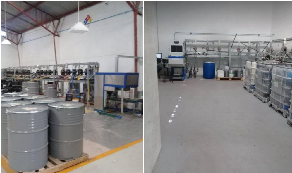
Figura 5 Dosificadoras de Componentes y Bases para la elaboración de tintas solventes y acuosas.
