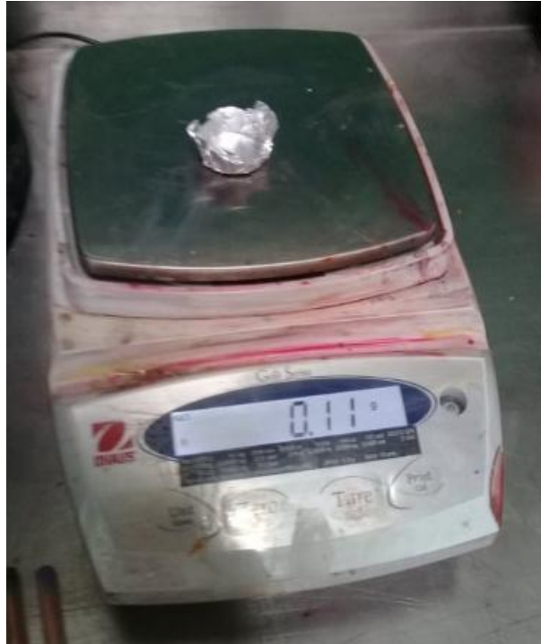
Figura 11 Balanza para Pruebas de % Sólido Fuente: QSI S.A Elaborado por: investigador
