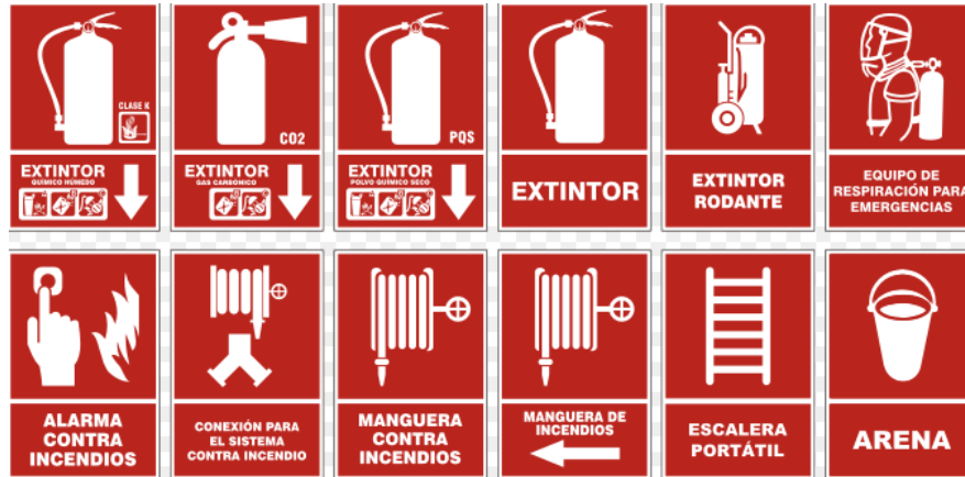
Figura 15.- Señales contra incendios. Fuente: NTP 188 DEL INSHT DE ESPAÑA Elaborado por: Investigador
