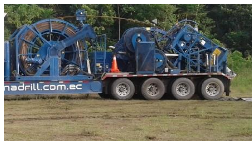
Figura 5: Carreto de tubería continua Fuente: Dynadrill Ecuador C.A. Elaborado por: Andrea Yerovi.
