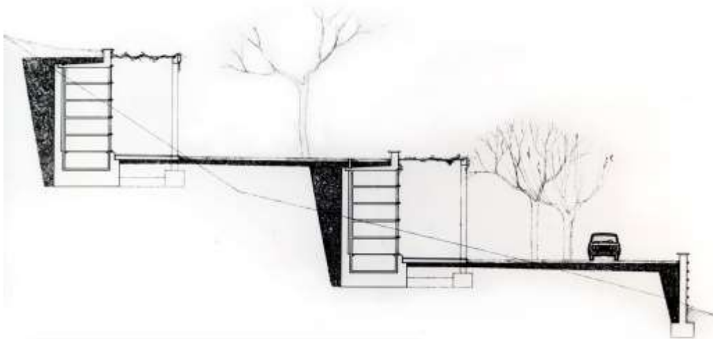
Imagen 19: corte de los nichos del cementerio de Roques Blancaea.
