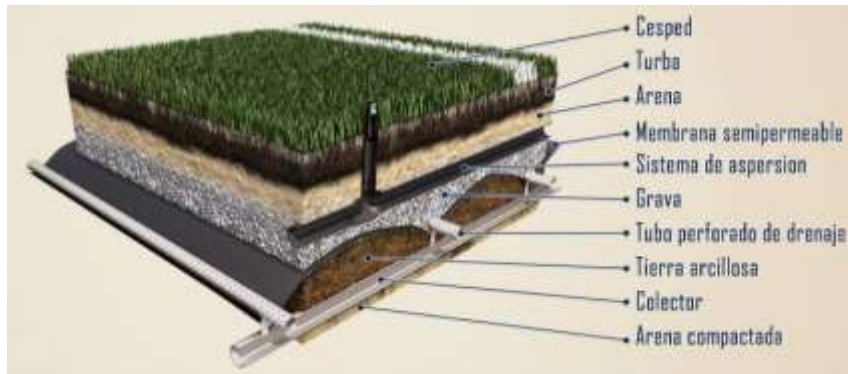
Imagen 85: Sistema de drenaje
