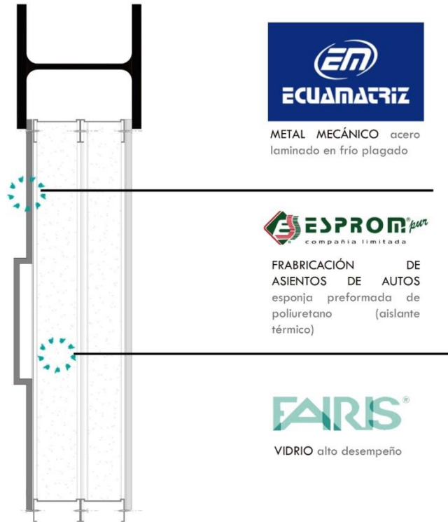
Gráfico 37. Sección de pared Elaborado por: Andrea Urbina, 2019
