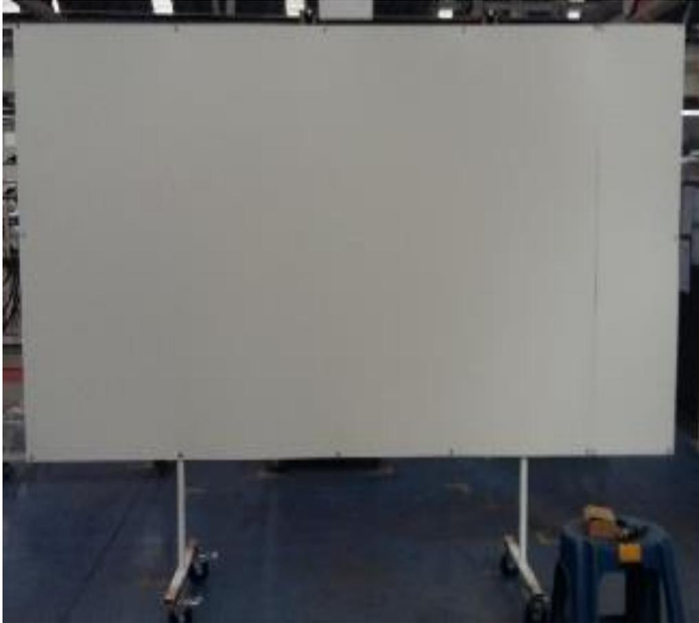
En la imagen describe el tablero físico luego del corte, pulido, soldado, pintado y la colocación de placa MDF, listo para la continuación de la implementación.
