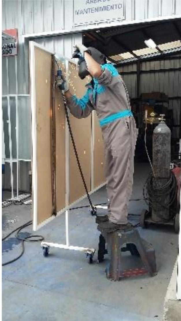
En la imagen describe la unión de partes es decir la actividad de suelda de los ángulos para la elaboración del tablero de control de calidad en operaciones.
