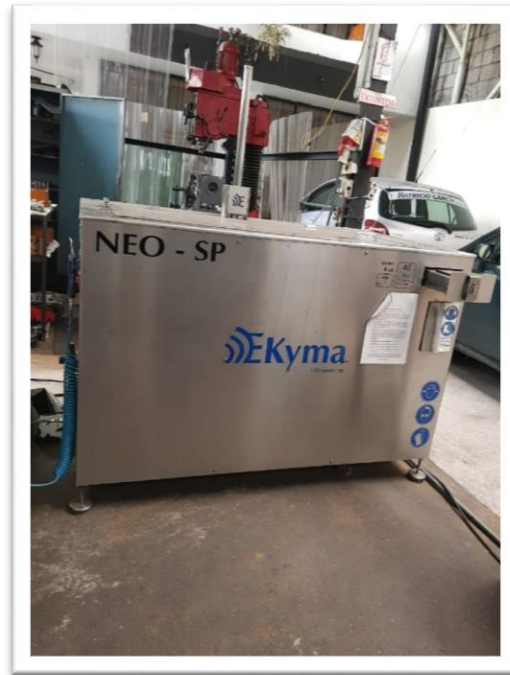
Imagen 28- Lavado por Ultrasonido Realizado por: William Piedra
