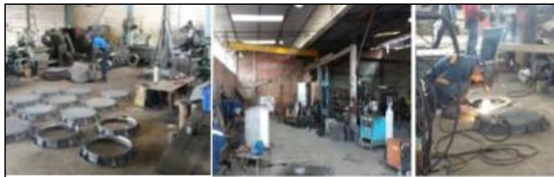
**Imagen 6** Mecanizado de las tapas de alcantarilla
