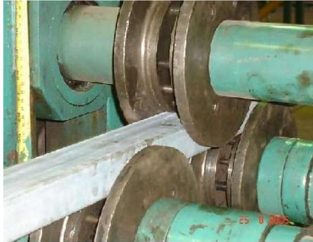
**Imagen #2:** Rodillos o matrices en forma vertical las cuales son impulsados por los operarios para producir el barolado
