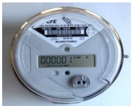
Imagen No. 3: Medidores de energía eléctrica Fuente: Global Energy
