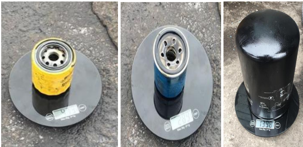
Ilustración 4.- Peso de filtros de aceite de automóvil, camioneta y camión y/o buses. Elaborado por: Carla Guillén
