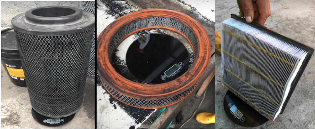
Ilustración 8.- Tipos de filtros de aire
