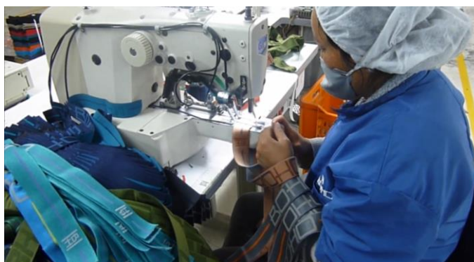
Imagen N° 12 Atraque de elástico Elaborado por: Andrés Nicolás Aguilar Ll. Fuente: Investigación Directa
